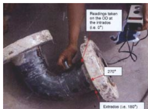
Gambar 3.17 Pengukuran ketebalan pada wing
