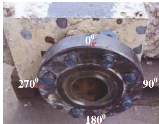
Gambar 3.15 Layout pengukuran ketebalan pada wing valve [1]
