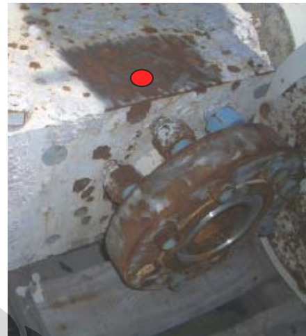
Gambar 3.12 Pengukuran kekerasan pada wing valve [1]
