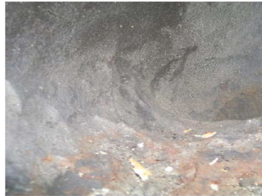
Gambar 3.8 Pengikisan logam bagian dalam master block [2]
