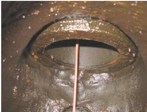
Gambar 3.7 Pengikisan pipa PSV [1]
