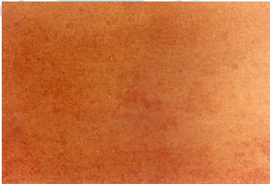
Gambar 4.23. Foto makro sampel dengan pembesaran 10x setelah perendaman pada 0,5 \text{ mol HCO}_3^- dengan \text{CH}_3\text{COOH} 10 ppm
