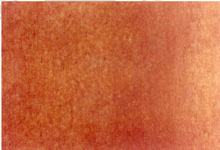
Gambar 4.27. Foto makro sampel dengan pembesaran 10x setelah perendaman pada 0,5 mol \text{HCO}_3^- dengan \text{CH}_3\text{COOH} 50 ppm
