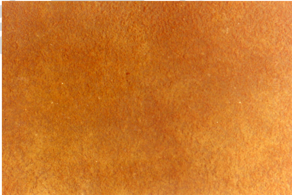
Gambar 4.15. Foto makro sampel dengan pembesaran 10x setelah perendaman pada 0,1 \text{ mol HCO}_3^- dengan \text{CH}_3\text{COOH} 10 ppm
