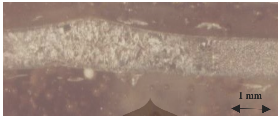
Gambar 4.4. Struktur makro hasil las Gas Tungsten Arc Welding (GTAW) pada baja lembaran setebal 1mm berlapis seng, pembesaran 7x, dengan etsa Nital 3%
