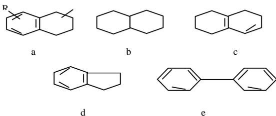
Gambar 1. Struktur molekul penyusun kerosin [6]
