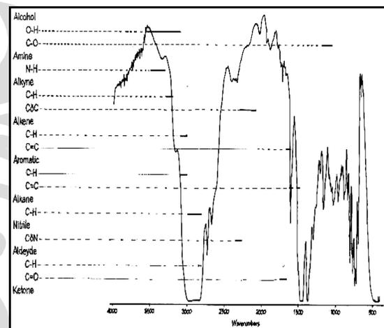
Gambar 6. Gugus-gugus fungsi molekuler penyusun kerosin sebelum magnetisasi, yang diamati dengan FTIR
