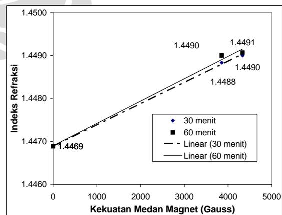
**Gambar 10.** Kurva pengaruh magnetisasi pada berbagai kekuatan medan magnet dengan sistem dipol terhadap kepolaran molekuler pada kerosin
