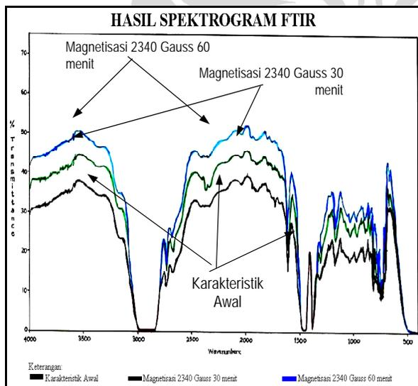
**Gambar 9.** Kurva pengaruh magnetisasi pada berbagai lama magnetisasi dengan sistem dipol terhadap kepolaran molekuler pada kerosin
