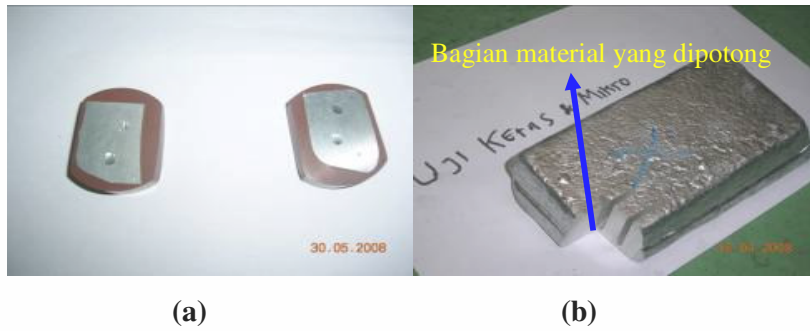
Gambar 3.15 (a) Sampel Uji Aus (b) Tempat Pengambilan Sampel Uji Aus
