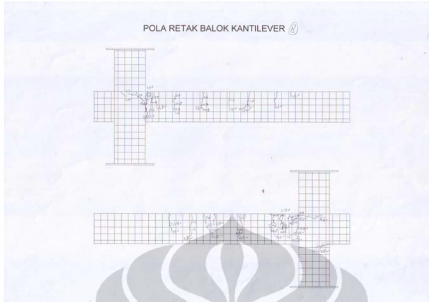
Gambar 4.54 Pola Retak M-1.3 Sesudah diperkuat : P=1,42 kN
