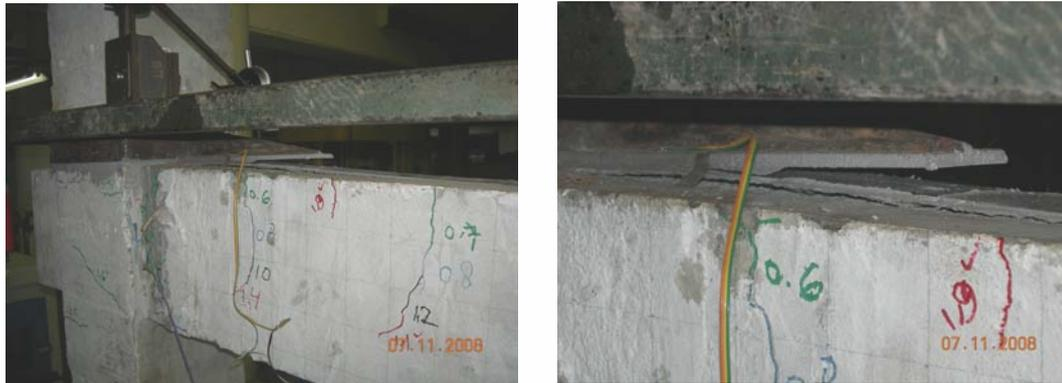
Gambar 5.2 Pelat pada Balok yang Lepas (Model-3)
