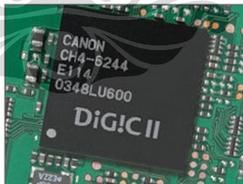
Gambar 2.13 DSP pada kamera DSLR Canon EOS 350D
