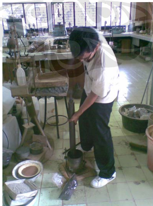
Gambar 4.1 Pemadatan menggunakan modified proctor
