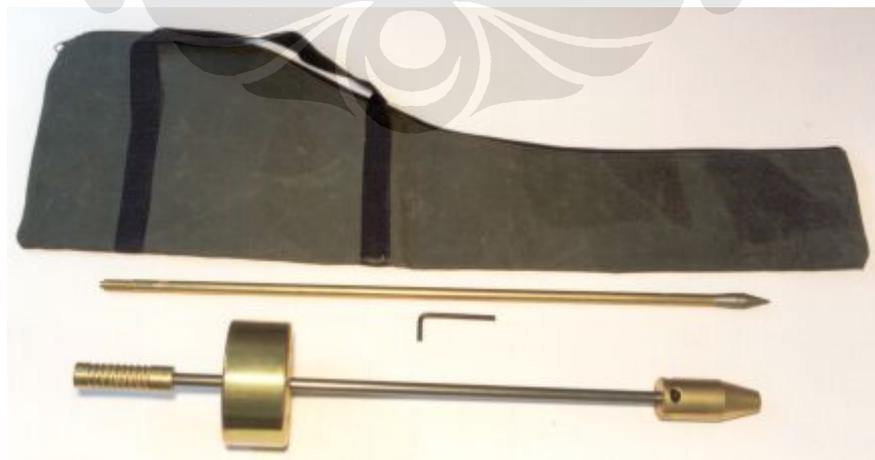
Gambar 2.6 Bagian – bagian alat *Dynamic Cone Penetrometer*
