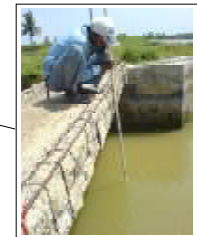
Pengukuran kedalaman saluran pada Pagedangan Ilir 2 bagian hulu
