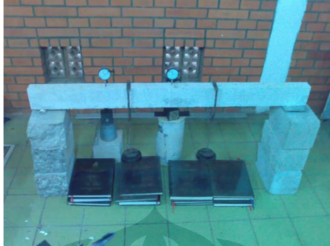
Pembebanan Balok 1 Tipe B
