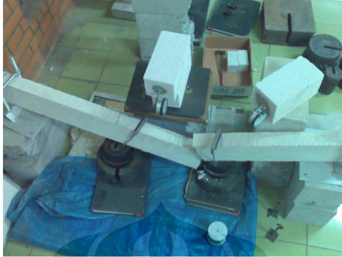
Keruntuhan Balok 1 Tipe A
