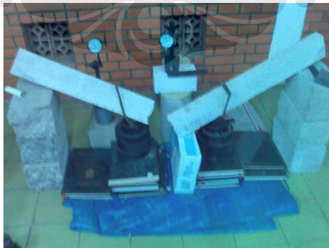
Keruntuhan Balok 1 Tipe B
