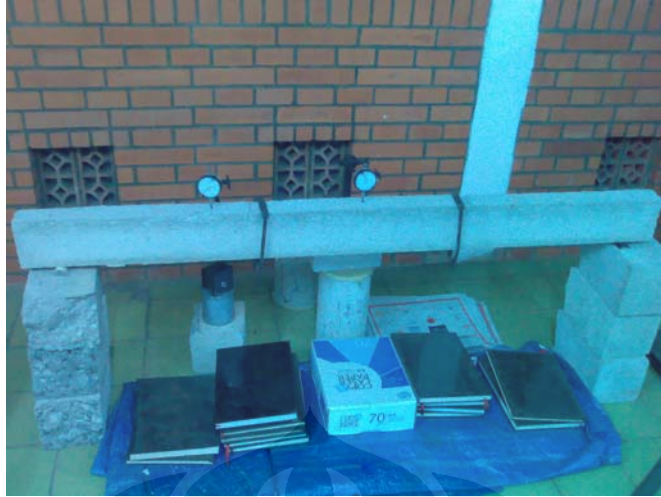
Pembebanan Balok 2 Tipe B
