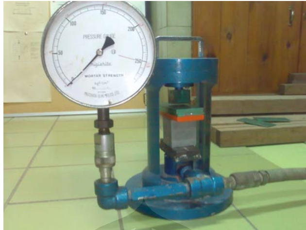
Pengujian Kuat Tekan Hancur Agregat
