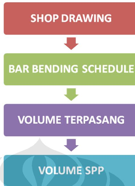
Gambar 3.2 Flow chart perhitungan *waste* besi tulangan
