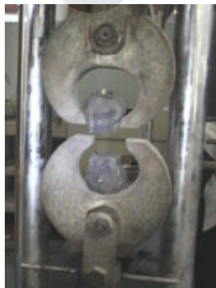
Gambar 4.17. Pengujian Kuat Tarik Sampel Angka 8
