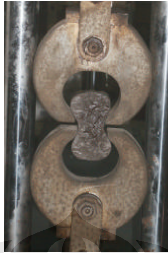
Gambar 4.13. Benda Uji Direct Tension Pada Saat Pengujian Kuat Tarik
