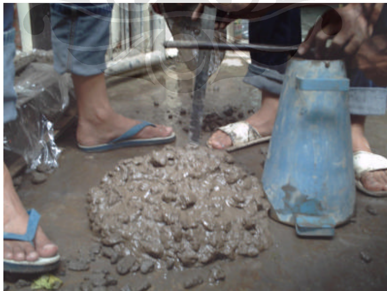
Gambar 4.8. Pengujian Slump Campuran Beton Geopolimer IV
