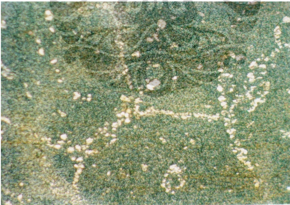
Struktur mikro dari Paduan A dengan Tempering 640 o C Perbesaran 500X
