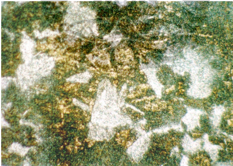
Struktur mikro dari Paduan E dengan Spherodized Anneal 810°C Perbesaran 500X
