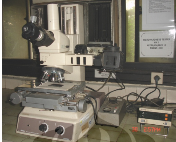
Gambar 3.12. Mikroskop Pengukur Jejak
