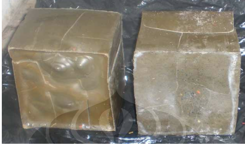
Gambar 4.2. Pola Retak Sampel Kubus Plastik (15x15x15) cm Akibat Susut
