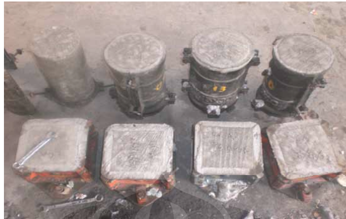
Sampel Kubus dan Silinder Beton Ringan Dalam Cetakan
