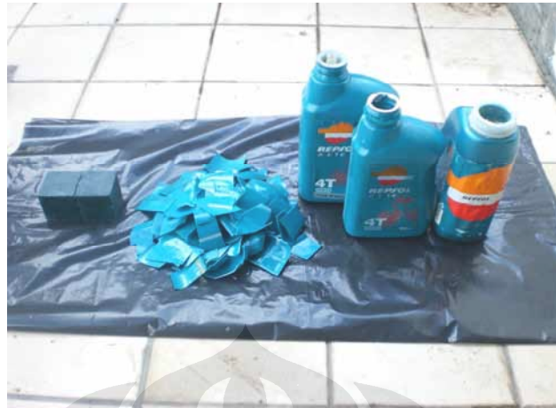
Contoh Botol, Potongan dan Kubus (5x5x5) Tipe Repsol
