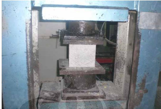
Pengetesan Kubus (15x15x15) cm Beton Ringan
