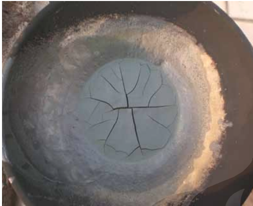
Contoh Agregat Yang Telah Kering Dalam Wajan
