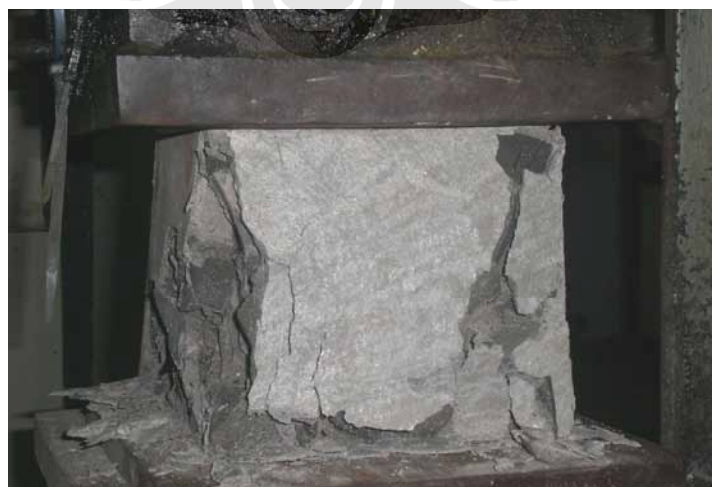
Pola Hancur Retak (15x15x15) cm Beton Ringan
