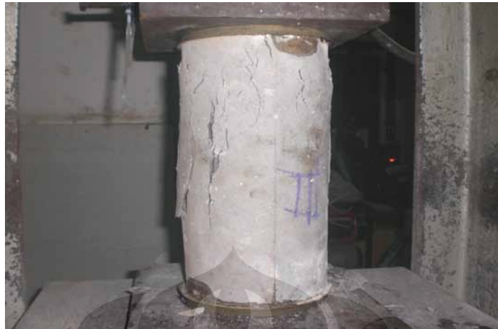
Pengetesan dan Pola Retak Silinder Beton Ringan
