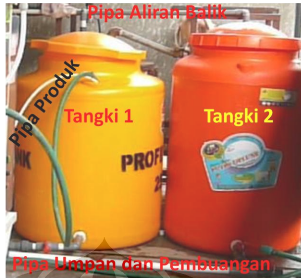
Gambar 3.6. Tangki Umpan dan Produk dan Sistem Perpipaan
