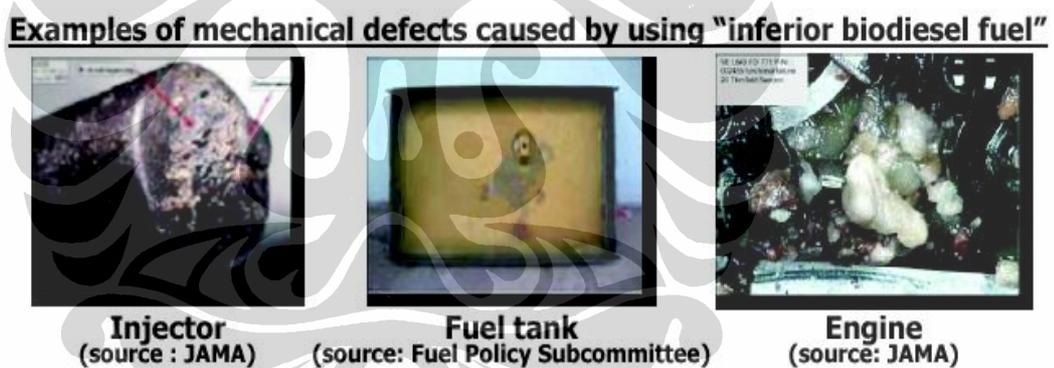
Gambar. 2.4. Contoh Kerusakan Karena Pemakaian Biodiesel Yang Mempunyai Stabilitas Oksidasi Dibawah Standar
