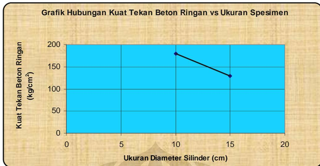
**Gambar 4.5 Hubungan Kuat Tekan Beton Ringan dengan Ukuran Spesimen**
