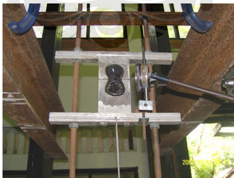
Proses Pengujian Kuat Tarik Agregat
