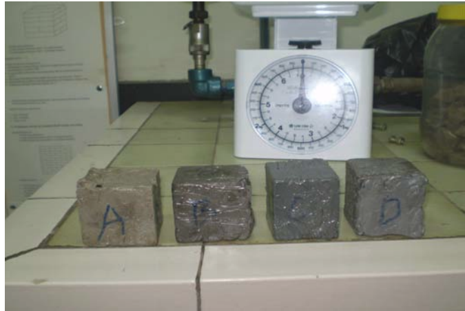
Sampel Pengujian Kuat Tekan Agregat
