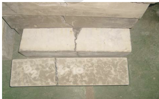
Pola Patahan Pada Sampel Hasil Pengujian Kuat Lentur
