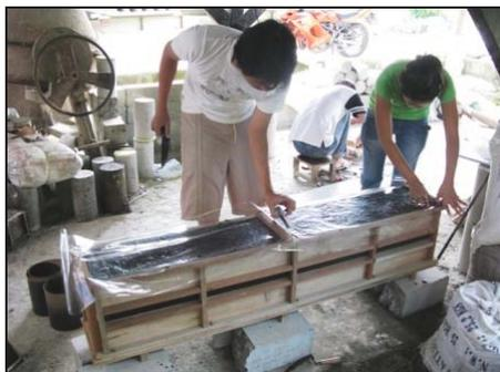
Gambar 4.3 Wrapping Pada Benda Uji
