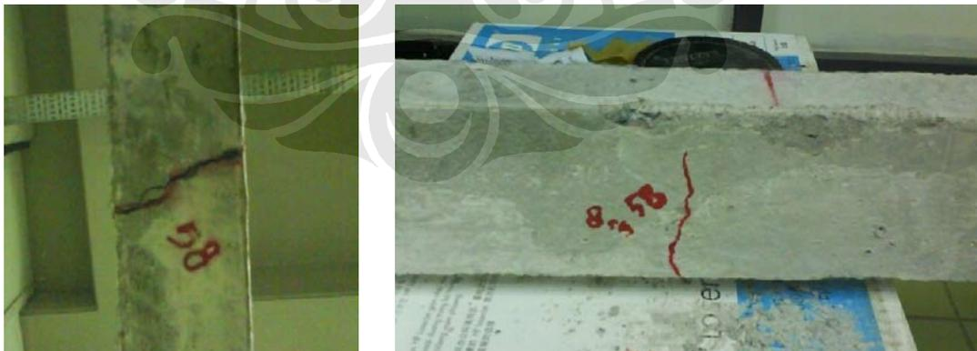
Gambar V.35. Foto keretakan dan pengukuran lebar retak Balok R 3%
