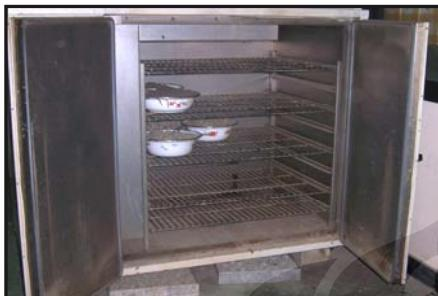
1. Agregat halus dimasukkan ke dalam oven selama 24 jam.
