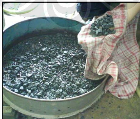
Gambar 3.6 Memperoleh kondisi SSD dalam analisa specific gravity and absorption dari agregat kasar
