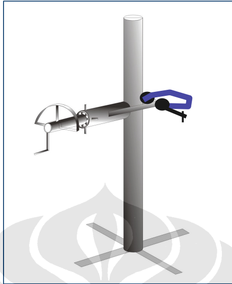
Gambar 3.9 Alat Penjatuh & Klem yang telah dimodifikasi
