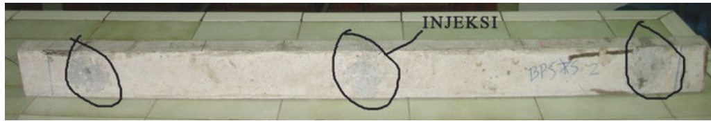
Gambar 4.5.52 Kondisi benda uji BPS-3 setelah perbaikan
