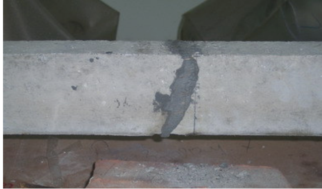
Gambar 4.5.1.(a) Kondisi patah BTS-1 akibat pengujian awal dan (b) kondisi yang telah diperbaiki.
