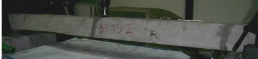
Gambar 4.5.34 Kondisi BPTS-2 hasil perbaikan dengan metode Injeksi
