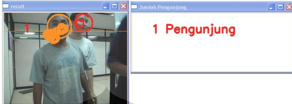
Pada gambar di atas, tinggal pengunjung kedua dan ketiga yang terdeteksi. Karena kedua pengunjung tersebut telah memasuki zona penghitungan, maka angka yang tertera di *counter* akan bertambah ketika proses pendeteksian wajah berhenti.
