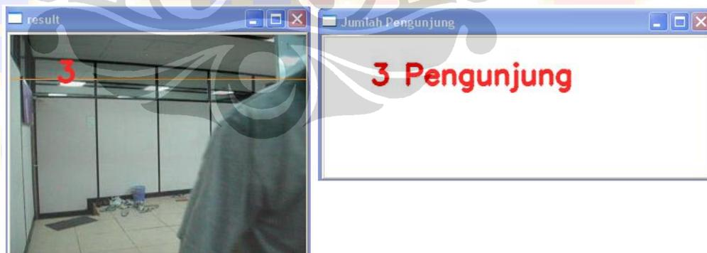
Pada kedua gambar di atas, proses pendeteksian wajah telah berhenti, dan pengunjung kedua dan ketiga telah memasuki ruangan, sehingga angka yang tertera pada *counter* bertambah dua.
