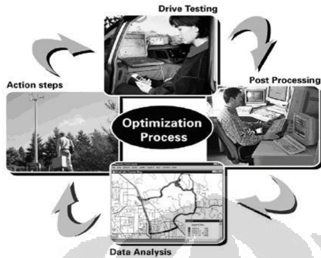
Gambar 5 Langkah - langkah Drive – Test untuk optimisasi Jaringan CDMA [Sumber : Telekomui Universitas Indonesia , 2008]
