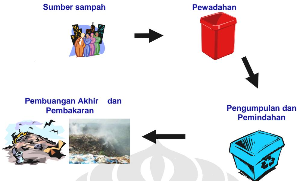
Gambar 5.3 Skema Sistem Pengelolaan Limbah Padat di Kelurahan Kalibaru
