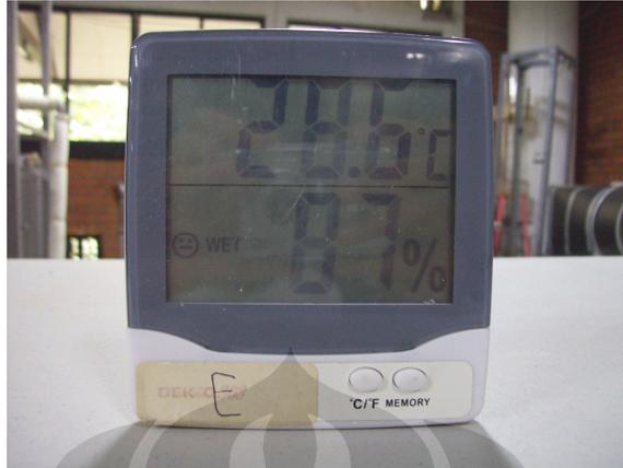
Gambar 3.11. Thermohigrometer.
