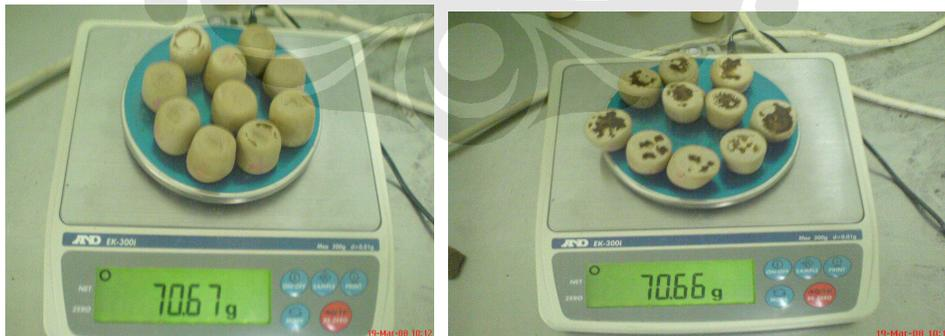
Gambar 3.36. Sampel nomor 1 setelah proses pengeringan, sebelah kiri tampak atas dari sampel dan sebelah kanan tampak bawah dari sampel.
