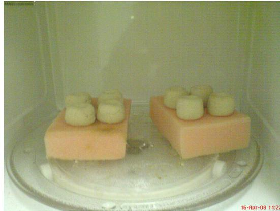
Gambar 3.45. Posisi sampel dengan alas spons pada *microwave*.
