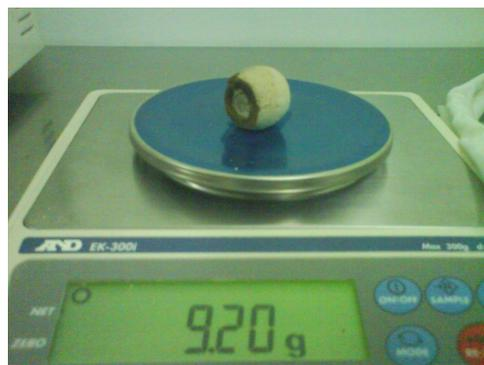
Gambar 3.25 Sampel nomor 7 setelah dilakukan pengeringan.
