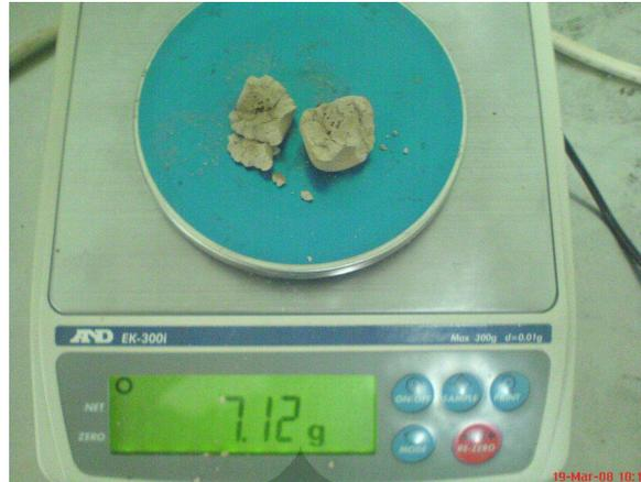
Gambar 3.37. Bagian tengah sampel nomor 1 setelah proses pengeringan.
