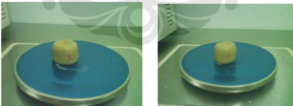
Gambar 3.19. Sampel sebelum dilakukan pengeringan (sampel no. 4 tetap dalam *microwave* sedangkan sampel no.3 ditimbang beratnya tiap 1 menit).
