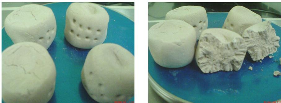
Gambar 3.51. Hasil pengeringan dengan menggunakan *microwave* pada sampel dengan alas spons dan *pre-treatment* kamar pendingin.
