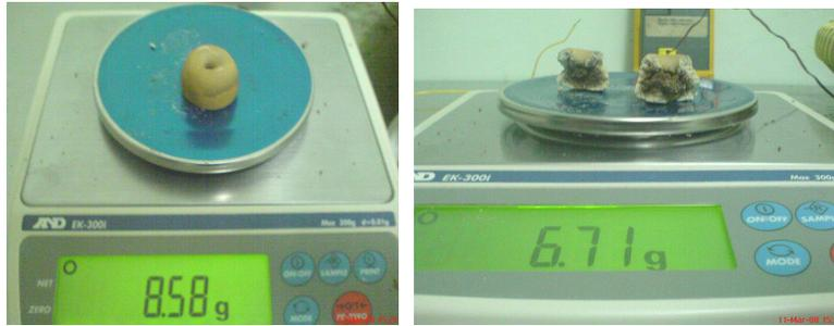
Gambar 3.32. Hasil pengeringan kelompok lubang pada bagian tengah, gambar sebelah kiri adalah tampak atas sedangkan sebelah kanan bagian tengah dari sampel.
