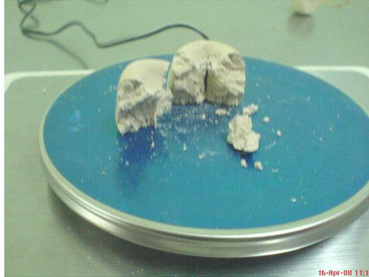
Gambar 3.44. Bagian dalam sampel dengan alas kaca setelah proses pengeringan.
