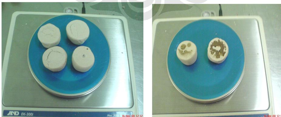
Gambar 3.48. Perbandingan antara sampel ( kiri ) yang menggunakan alas ( baik spons maupun kasa ) pada saat proses pengeringan dan yang tidak menggunakan alas ( kanan ).
