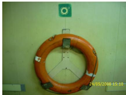
**Gambar 6.10. *Lifebuoy with light* yang lampunya hilang**
