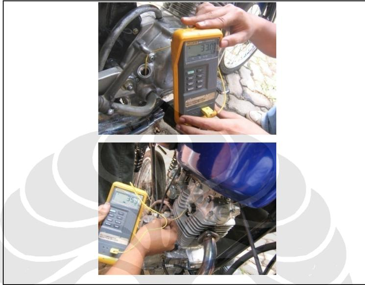
**Gambar 3.10** Pengukuran temperatur oli dan temperatur busi
