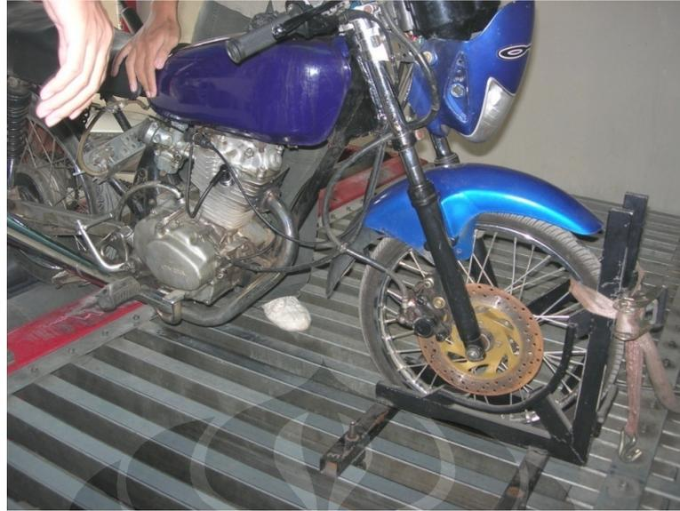
**Gambar 3.6** Pengikatan motor dan penempatan diatas *roller*
