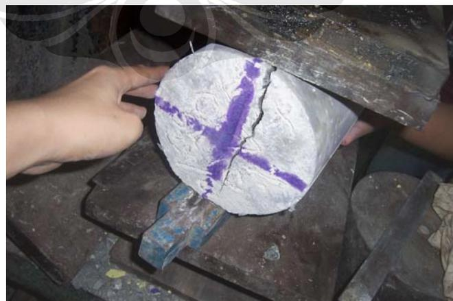
Gambar 4.10. Pola Retak Benda Uji TB-7-0,7-2
