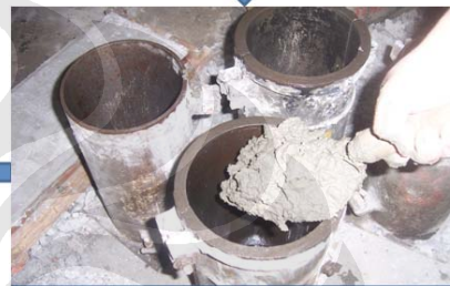
3. Masukkan beton ke dalam mold dalam 3 lapisan, setiap lapisan dilakukan pemadatan 25 kali
