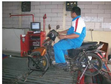
**Gambar 3.3.** Pengikatan motor dan penempatan diatas roller
