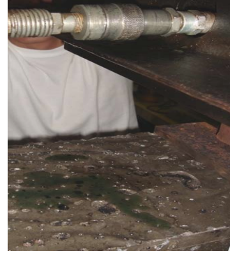
Gambar 4.15 Tetesan Pelumas di Penampang Balok
