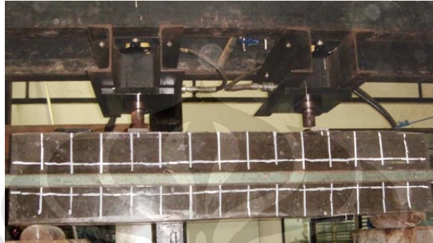
Gambar 4.13 Balok dengan 2 Actuator Pembebanan
