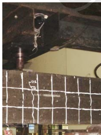
Gambar 4.24 Retak Penampang Balok Depan pada Beban 40 kN Loading 2
