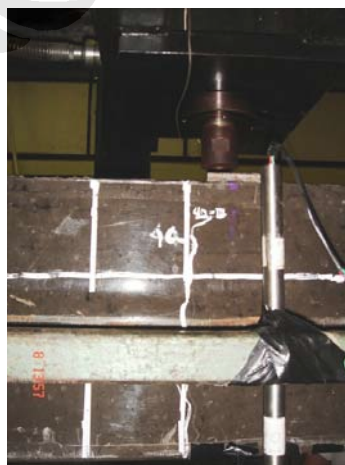
Gambar 4.25 Retak Penampang Balok Belakang pada Beban 40 kN Loading 3
