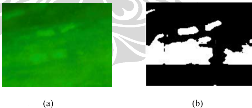
Gambar 4.4 Perbedaan Intensitas antara Dua Buah ROI yang Berdekatan (a) ROI pada citra masukan (b) Setelah dilakukan proses segmentasi, ROI yang memiliki kontras rendah menjadi tak terlihat.
