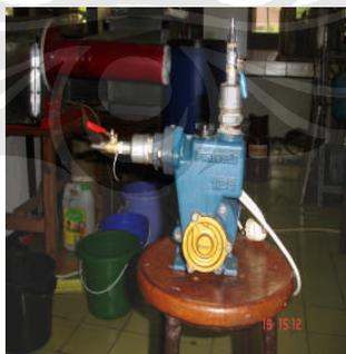
Gambar 3.6. Pompa sentrifugal
