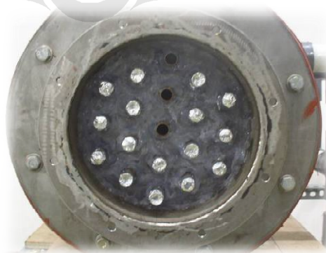
Gambar 4.2.tube end bagian dalam adsorber
