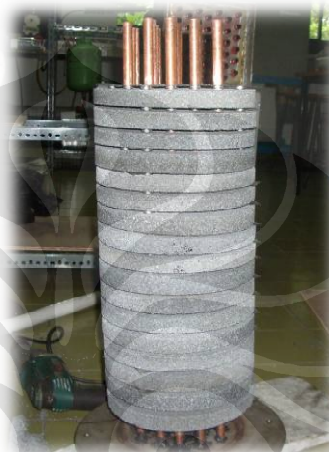
Gambar 4.1.susunan adsorber pada desain terdahulu
