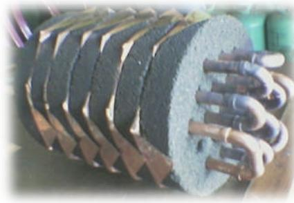
**Gambar 3.6. tube tembaga dan u-bent tembaga pada adsorber**
