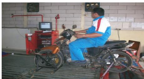
Gambar 3.2 Pengikatan motor dan penempatan diatas roller
