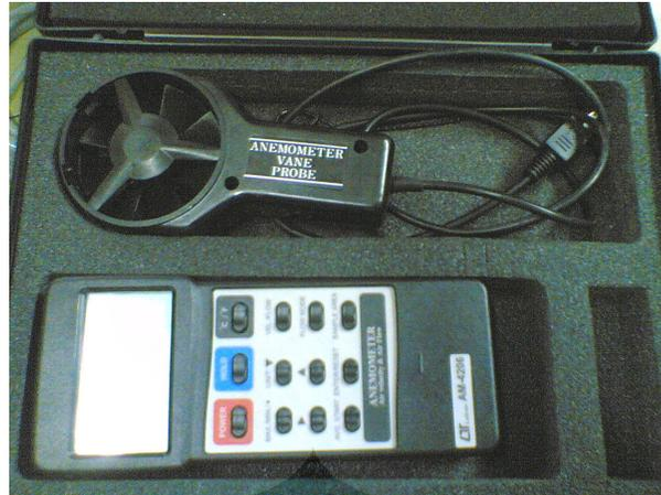
Gambar 3.2 Anemometer
