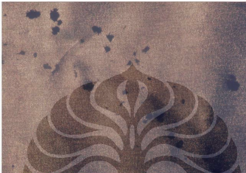
Gambar 4.26. Foto makro sampel setelah dianodisasi dengan larutan \text{CH}_3\text{COOH} 0,2 M, temperatur 40 °C, potensial 10 volt, pembesaran 10 X
