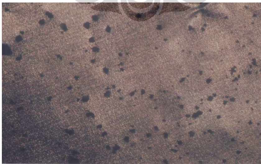
Gambar 4.17. Foto makro sampel setelah dianodisasi dengan larutan \text{CH}_3\text{COOH} 0,2 M, temperatur 4 °C, potensial 10 volt, pembesaran 10 X
