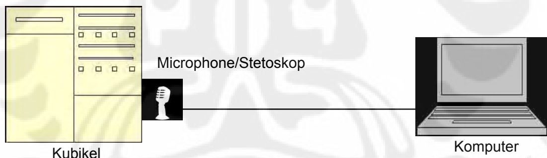
Gambar 3.1. Rangkaian pengujian pada gardu
