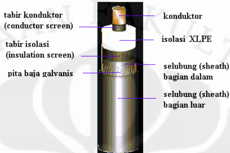
Gambar 2.1 Konstruksi kabel XLPE
