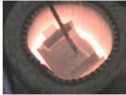
Gambar 3.12 Proses pemanasan kembali ingot komposit Al5Cu/ AL 2 O 3 untuk mencapai fasa semisolid .
