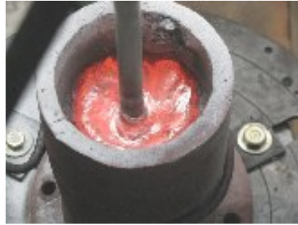
Gambar 3.11 Proses steering cairan aluminium-tembaga sambil melakukan pencampuran partikel alumina secara bertahap.
