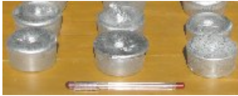
Gambar 3.9 Paduan Al5Cu hasil pengecoran.
