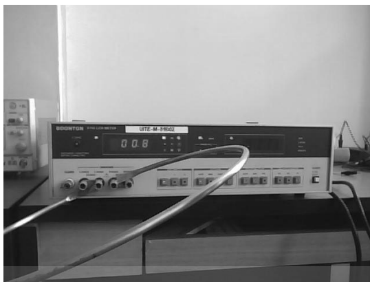
Gambar 3.16 Pengukuran Induktansi Antena Penerima Tembaga setelah Pelapisan dengan Menggunakan RLC Meter
